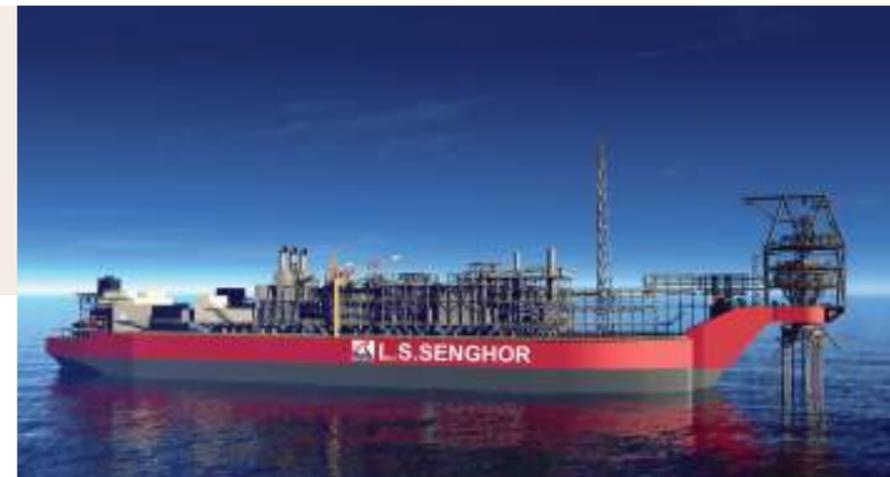
Le FPSO Léopold Sédar Senghor est un navire spécialement conçu pour le traitement des hydrocarbures et le stockage de pétrole.
